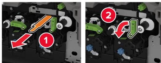
**9** Nehmen Sie das Druckkopfwischblatt heraus und reinigen Sie die Druckkopflinsen.
