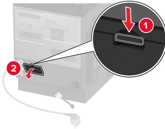
**9** Schließen Sie den Fach-Steckverbinder an den Drucker an, und bringen Sie anschließend die Abdeckung an.
