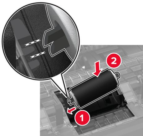
**7** Setzen Sie die Abdeckung der Trennrolle so ein, dass sie *hörbar* einrastet.
