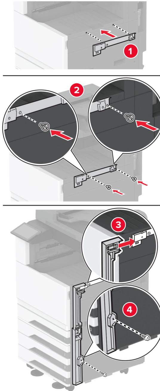
**11** Setzen Sie den Papiertransport ein und befestigen Sie ihn mit den Schrauben.
