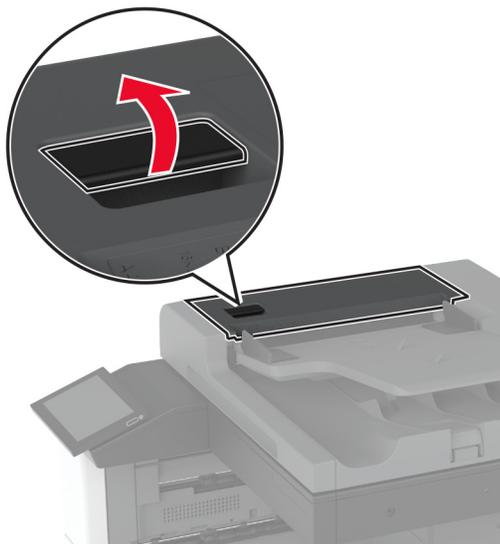
**3** Entfernen Sie die Abdeckung der Trennrolle.
