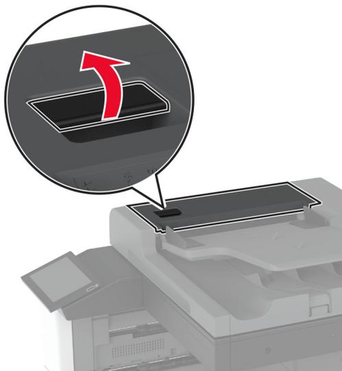
**3** Entfernen Sie die Abdeckung der Trennrolle.
