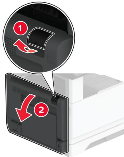
**2** Öffnen Sie Klappe A1 und entfernen Sie anschließend u. U. gestautes Papier.
