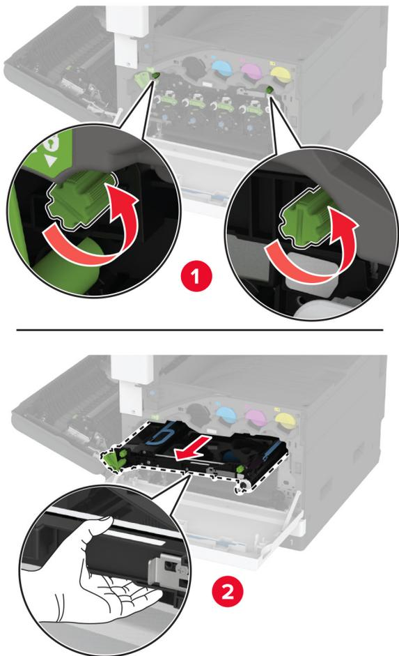
6 Entfernen Sie das gebrauchte Transfermodul.
