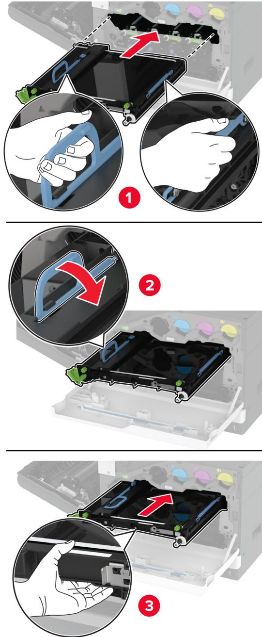
**9** Verriegeln Sie das neue Transfermodul, und schließen Sie Klappe A.
