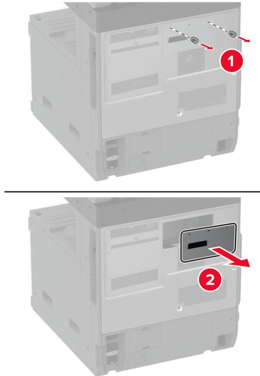
**5** Entfernen Sie die Controller-Platinenabdeckung.
