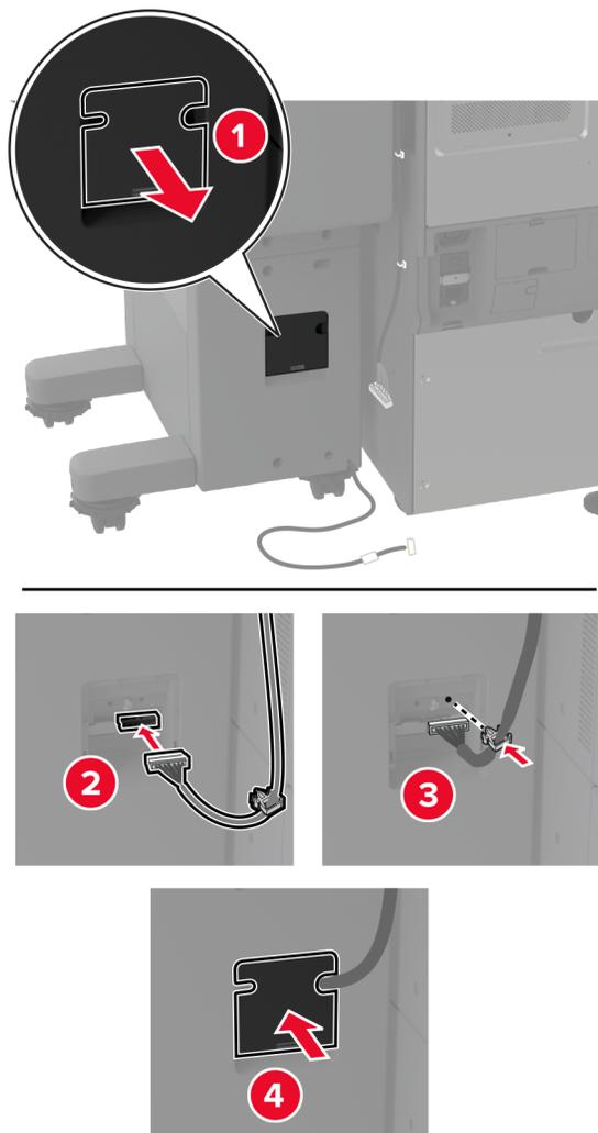
**18** Schließen Sie das Finisher-Kabel an der Rückseite des Druckers an.
