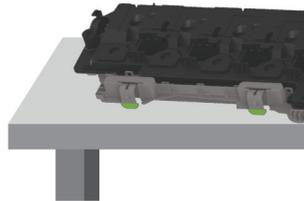
**8** Nehmen Sie das Druckkopfwischblatt heraus und reinigen Sie die Druckkopflinsen.
