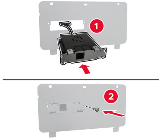
**8** Stecken Sie das Faxanschlusskabel am Fach für die Steuerungsplatine ein.
