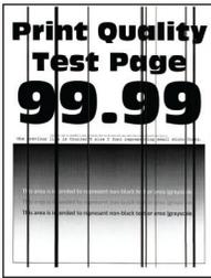
**Hinweis:** Drucken Sie die Testseiten aus, bevor Sie das Problem beheben. Berühren Sie auf dem Startbildschirm die Option **Einstellungen > Fehlersuche > Testseite drucken**.
