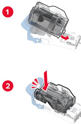
**6** Setzen Sie die Halterung der Heftklammerkassette ein.
