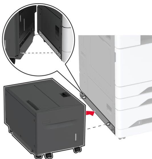
**7** Schließen Sie den Fach-Steckverbinder an den Drucker an.
