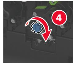
**8** Entfernen Sie das Verpackungsmaterial, und verriegeln Sie dann den oberen Teil.
