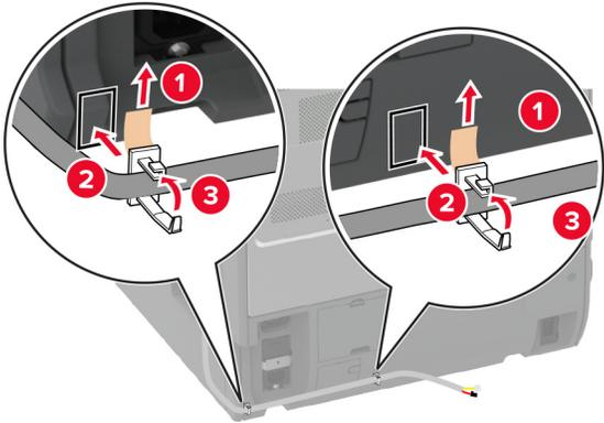
**13** Schließen Sie das Finisher-Kabel an den Drucker an.
