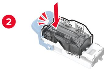
**6** Einsetzen der Halterung der Heftklammerkassette, bis sie hörbar *einrastet*.
